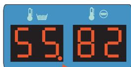
Die Auswahl der zusätzlichen Kühlung wird durch Einschalten des Dezimalpunkts auf dem Display angezeigt.
