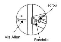
Retourner le chariot de service et visser les roues sur le cadre. Sous la roue, fixer la protection antichoc.
