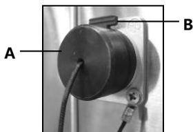
Zum Anschluss eines Kerntemperaturfühlers ziehen Sie die Abdeckkappe **A** (Abb. links) von der Anschlussstelle an der linken oberen Seite des Gerätes ab, halten Sie die rote Einraste-Vorrichtung **B** gedrückt und stecken den Kerntemperaturfühler **C** in die vorgesehene Öffnung.
