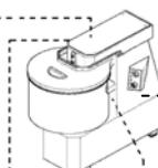
**Микровыключатель:** останавливает машину, когда поднимается головка. При последующем закрывании головки, запустить машину, нажимая кнопку I (только Мод.CNS-FN)
