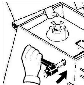
**1 ИНФОРМАЦИИ:** Перед каждым циклом работы проверять, чтобы вынимаемые детали были закреплены плотно к машине. Закрыть кастриюлю, поворачивая против часовой стрелки нижний фланец.
