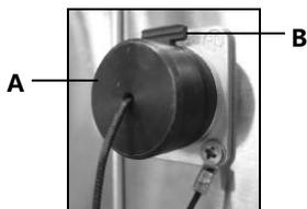
Pour placer la sonde de température à cœur, retirer le couvercle **A** (fig. ci-contre) du point de raccordement en haut à gauche de l'appareil, maintenir le fermetoir rouge **B** enfoncé et insérer la sonde de température à cœur **C** dans le trou prévu à cet effet. Relâcher ensuite le fermetoir **B**.
