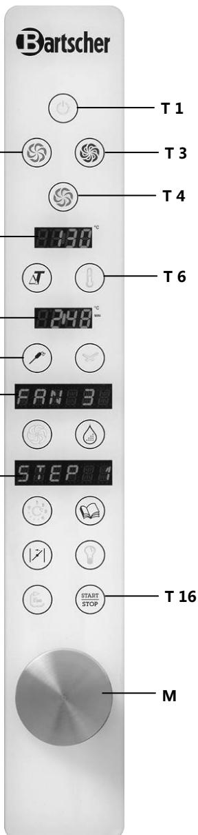
Для включения прибора следует нажать кнопку **T1**. Функциональные кнопки **T 2 – T 3 – T 4** мигают, а прибор готов к установке функции. На ЖК дисплее **D 4** появится „**MANUAL**“ (ручной режим).
