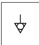
Fig. – Abb. 22: Simbolo equipotenziale \ Symbole equipotenzial \ Equipotenziale label \ Äquipotenzial Symbol \ Equipotenzial símbolo
