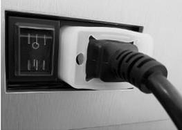
1. Basculer l'interrupteur d'alimentation à l'arrière de l'appareil.
