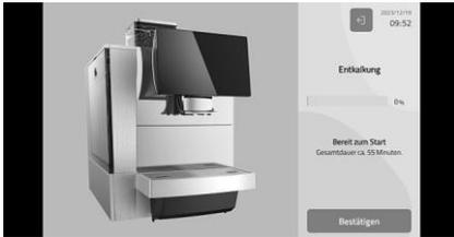
Mettre en marche le programme de détartrage quand l'écran d'affichage affiche le message « Détartrage du circuit de café ». Pour le détartrage, utiliser un produit détartrant en poudre ou liquide.
