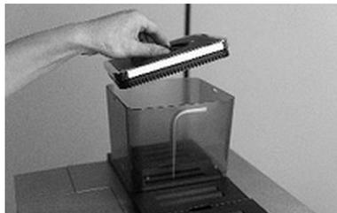
1. Dévisser le couvercle du réservoir à grains à l'aide de la clé fournie.
