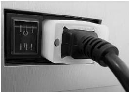
Raccorder le câble d'alimentation à l'arrière de l'appareil.
