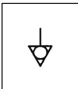
Fig. – Abb. 3: Simbolo equipotenziale \ Symbole equipotenzial \ Equipotenziale label \ Äquipotenzial Symbol
