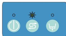
Se la macchina è dotata dell'optional addolcitore, questo sarà completamente automatico. Quando si renderà necessario, eseguirà un mini-ciclo della durata di 120". In questa fase la spia **F** si accende. Se necessario il ciclo può partire anche nella fase di carico della vasca. Se interviene durante il ciclo di lavaggio, questo viene allungato.
