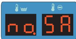
Quando sul display compare **NO SA** (in alternanza alle temperature vasca e boiler, e solo se la macchina non sta lavando) significa che è finito il sale nel contenitore posto nella vasca (solo su macchine con optional rigenerazione).
