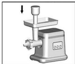
7. Fissare il bastoncino in plastica in modo che la tacca coincida con il perno dell'alloggiamento della coclea. Montare il cono e fissarlo con la ghiera di sicurezza all'alloggiamento della coclea.
