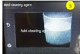
Placer dans une tasse le flexible à lait avec du produit de nettoyage.
