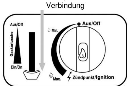
5. Drehen Sie anschließend den Einstelldrehregler (11) ganz nach links auf „Zündposition/Ignition“ (12), bis das Klicken der Zündung erfolgt.
