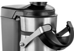
Der Deckel der Saftpresse wird mit dem **Verriegelungs-bügel mit Abdeckung** festgeklemmt, dabei entsteht bei korrekt zusammengesetztem Gerät über den integrierten **Sicherheitsschalter** der Kontakt zum Motor, nur so ist die Inbetriebnahme des Gerätes möglich. Der Sicherheitsschalter stoppt den Motor sofort, wenn der Verriegelungs-bügel mit Abdeckung gelöst wird.
