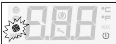
Este diodo LED indica el estado (de encendido o apagado).
