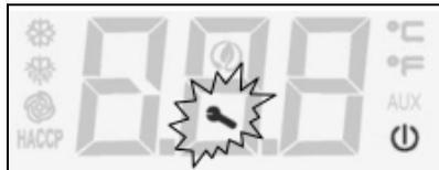
Este diodo LED encendido indica la necesidad de limpiar el filtro del condensador.
