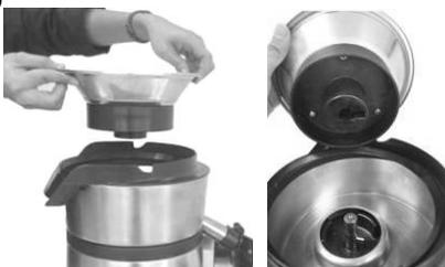
Опустить сетчатый микрофильтр (10) на чашу для сока (14) и закрепить на приводе двигателя (8), слегка поворачивая его так, чтобы штифт на приводе двигателя совпал с выемкой на дне сетчатого микрофильтра (10).
