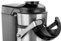
Крышка соковыжималки крепится **с помощью дуги блокировки с корпусом**, что позволяет при правильно собранном устройстве замкнуть контур двигателя благодаря встроенному **аварийному выключателю**, только в таком случае возможно включение прибора. Аварийный выключатель вызывает немедленную остановку двигателя в случае снятия дуги блокировки с корпусом.
