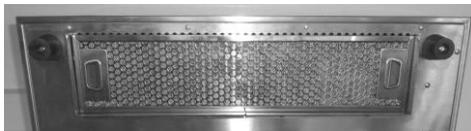
Der Staub- und Fettfilter soll verhindern, dass Schmutz oder Fett mit der vom Lüfter angesaugten Luft in das Gehäuse gelangen.
