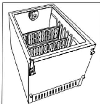
7. Retire los tornillos superiores izquierdos y sus cubiertas.
