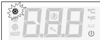
Ce témoin LED signale l'état de fonctionnement (marche ou arrêt) du COMPRESSEUR
