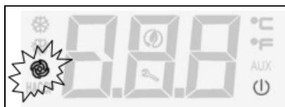
Ce témoin LED signale l'état de fonctionnement (marche ou arrêt) du VENTILATEUR
