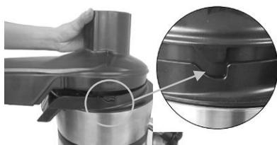
Placer ensuite le couvercle (6) en veillant à ce que les languettes du couvercle (6) correspondent aux entailles de la bague intermédiaire (12).
