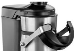
Le couvercle de la centrifugeuse est fixé à l'aide d'un **étrier de verrouillage avec protection**, ce qui permet, lorsque l'appareil est assemblé correctement, de fermer le circuit du moteur grâce à un **rupteur d'urgence** intégré, et l'appareil peut être mis en marche seulement dans ce cas. Le rupteur d'urgence coupe immédiatement le moteur lorsque l'étrier de verrouillage avec protection est libéré.
