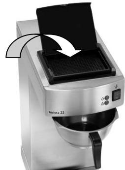
2. Retirer la corbeille de filtre avec insert et y placer un filtre en papier Bartscher adapté (code-no. **190014** ou **190015250**).
